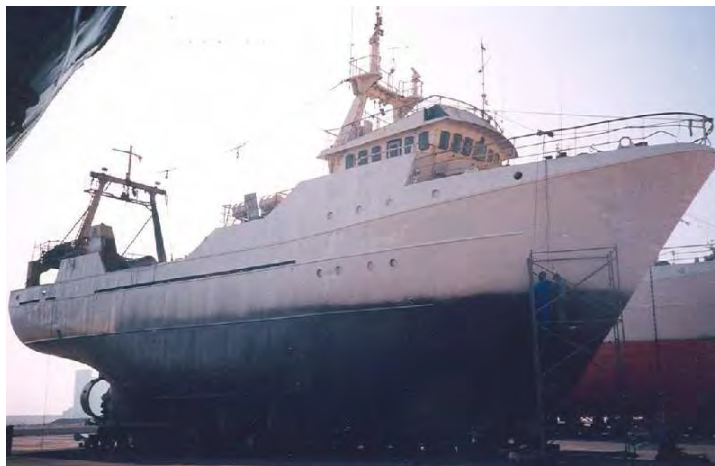
Navire de la pêche hauturière construit en acier Longueur supérieure à 24 mètres
