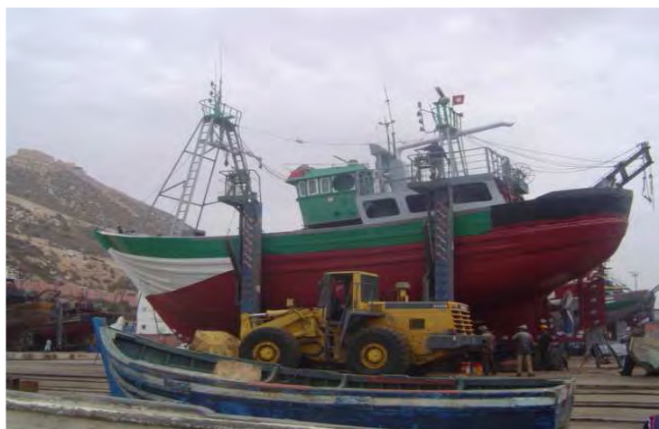
Navire de la pêche côtière construit en bois longeur Inférieure à 25 metre
